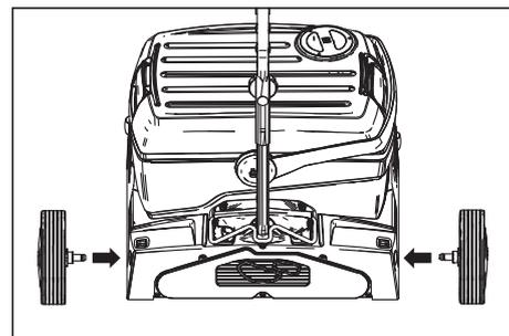
➔ Вставить оси транспортных колес в отверстия на приборе и зафиксировать.
